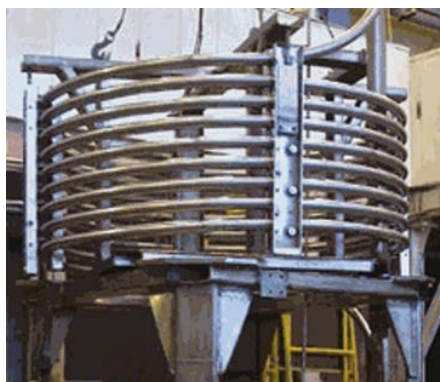
Обмотки из низкотемпературного сверхпроводника будут у магнитов, удерживающих плазму в ИТЭРе
