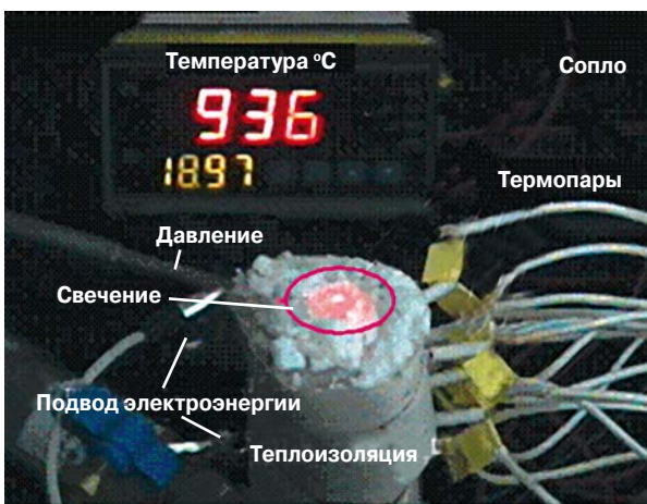
3 Лабораторный прототип однокомпонентного двигателя на закиси азота во время испытаний (выхлоп прозрачный)
