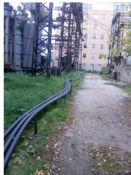
Трехфазный кабель из высокотемпературного сверхпроводника проходит испытания в Энергетическом институте им. Г.М.Кржижановского
